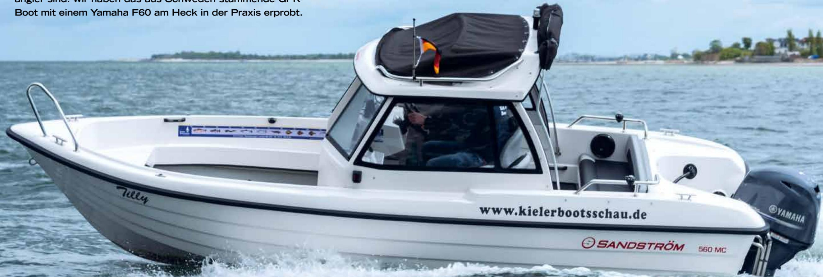
Während des SKIPPER-Tests auf der Kieler Förde stellt die Sandström 560 MC ihr sicheres Fahrverhalten unter Beweis. Die Topspeed-Messung ergibt 21,9 Knoten
